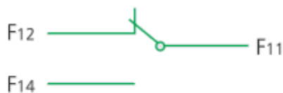
Disjuntor nas condições fechado ou aberto
