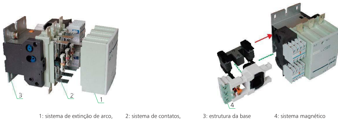
Estrutura dos contatores NC2-115~265
